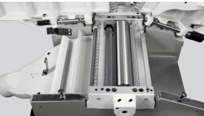
Gruppo pialla con albero in acciaio a 3 coltelli. Il rullo di entrata in acciaio è a dentatura elicoidale per facilitare l'introduzione dei pezzi. La pressione dei rulli di avanzamento è registrabile. Grupo cepilladora con eje en acero a 3 cuchillas. El rodillo de entrada en acero es a dentado helicoidales para facilitar la introducción de las piezas. La presión de los rodillo de avance es regulable por medio de tornillos de regulación.
