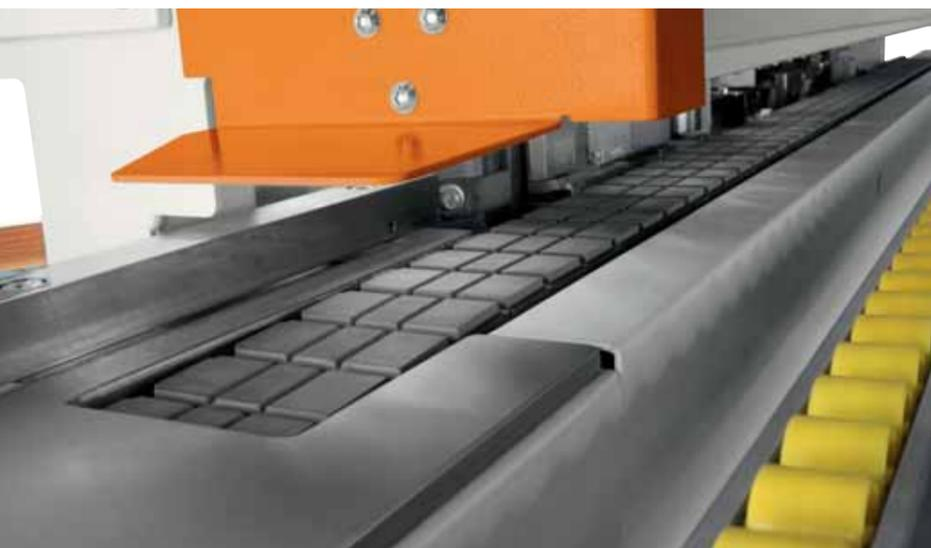
Rettilinearità d'avanzamento e alta resistenza ai carichi laterali grazie al sistema a cingolo con pattini ricoperti in gomma ad alta aderenza.
