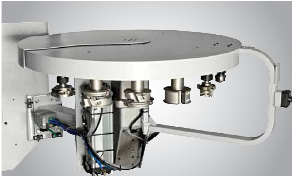
Magazzino rotativo posteriore a 16/24 postazioni 16/24-position rear rotary tool changer Almacén rotativo posterior a 16/24 posiciones
