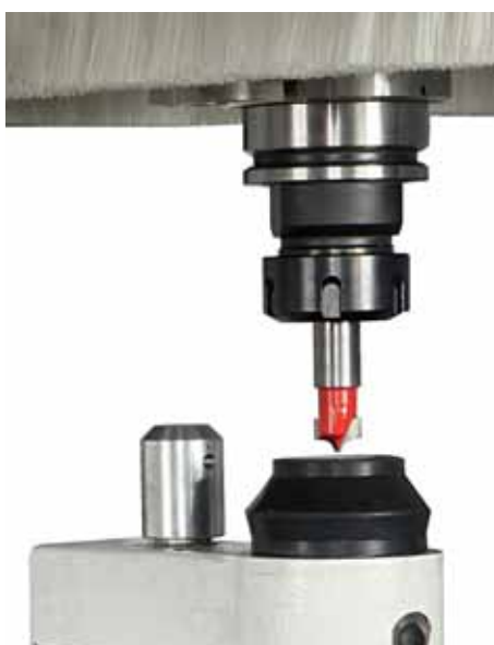
JET MASTER RT: Dispositivo pre-setting lunghezza utensile Tool length presetting device Dispositivo de pre-setting longitud herramienta
