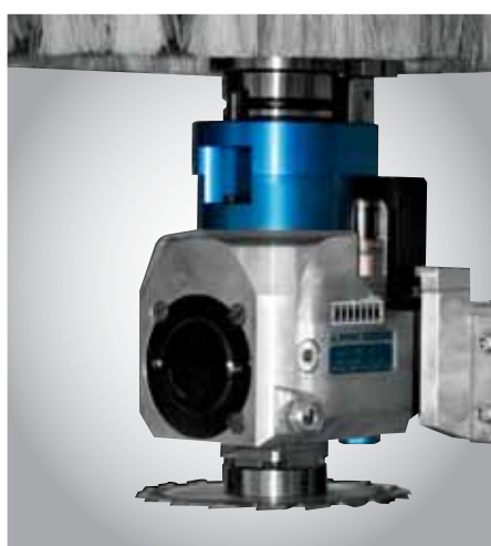
Trasforma il tuo centro di lavoro in una macchina a 4/5 assi grazie a "QinX", aggregato fresa/lama ad inclinazione variabile gestita da CN.
