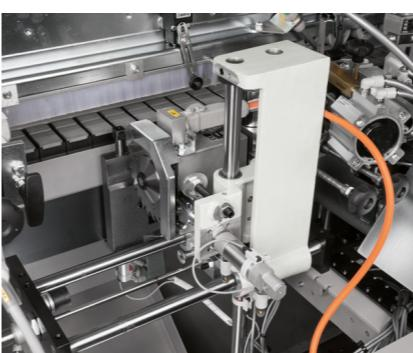
Gruppo Intestatore. Il gruppo è equipaggiato con 1 motore ad alta frequenza per il taglio del bordo anteriore e posteriore a 90° (standard su versione M6).
