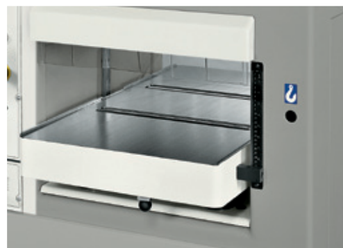
Piano spessore con due rulli folli , per ottimizzare avanzamento e produttività. Solo per PS 52, PS 63.
