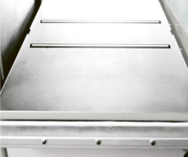
Mesa de cepillado con rodillos de deslizamiento | T4520
