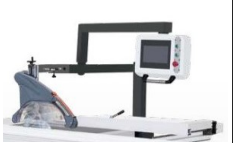
Pantalla táctil que facilita la introducción de medidas para el perfecto posicionamiento de los ejes.
