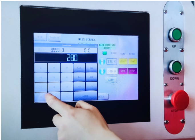
Pantalla táctil que facilita la introducción de medidas para el perfecto posicionamiento de los ejes.
