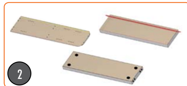
Perforaciones 5 caras (4 horiz. + 1 vert.) mas ranuras en eje X
