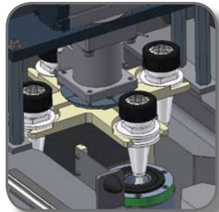
Cambio herramientas automatico, Nº4 posiciones (Y axis 1000 mm)
