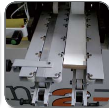
Dispositivo para piezas estrechas, hasta ancho min. 70mm
